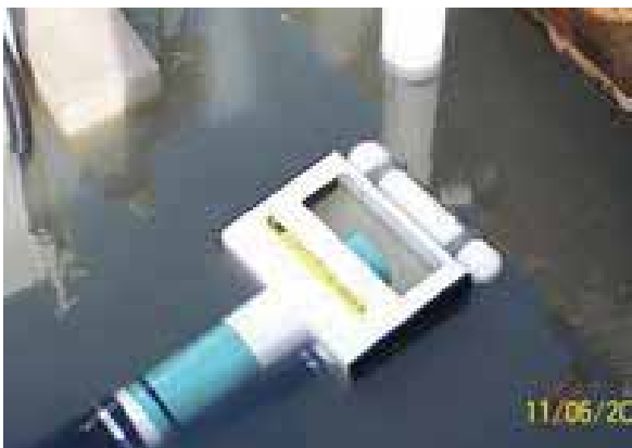
Figura 5.4.8. Sifón de descarga controlada (Fuente: Rissy Plastics)
