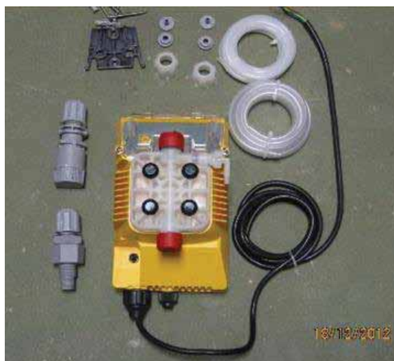
Figura 6.1. Bomba de dosificación de hipoclorito
